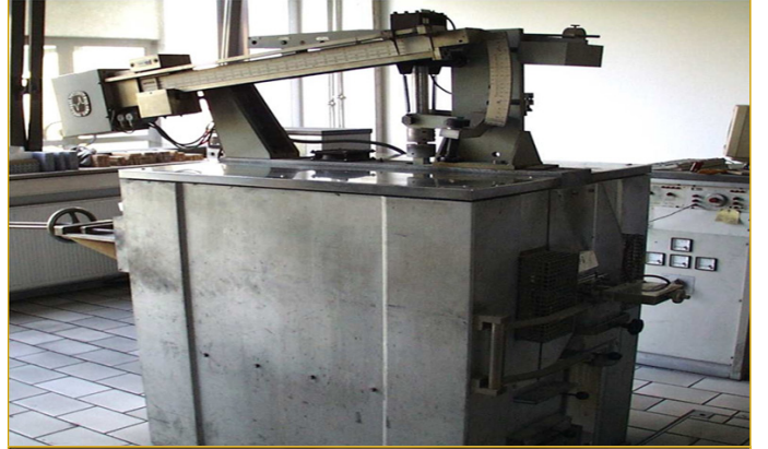
Şekil 5.15. Sıcakta Eğme Mukavemeti; HMOR Testi ve Fırın İçinde 3-Nokta Eğme Testi 70
