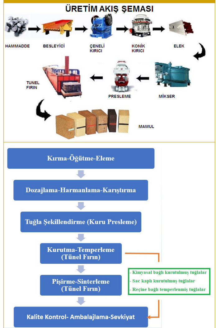
Şekil 3.3a-b. Refrakter Tuğla Üretim Prosesinin Aşamaları. 36
