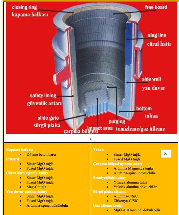
Şekil 6.2a-b. Bir Çelik Potasının Örümü için Güncel Önerilen Refrakter Malzemeler 17,19,36
