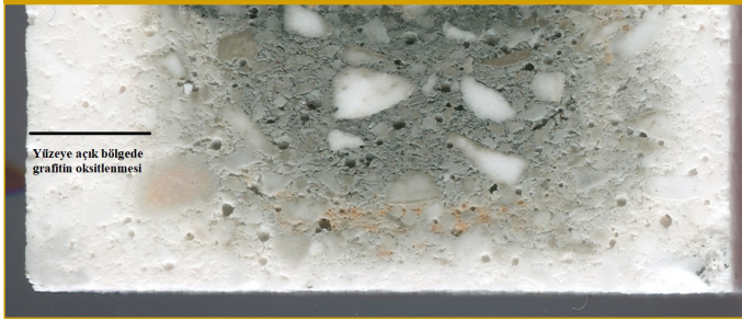
Şekil 3.21. Grafit Katkılı Refrakter Yüzeyinden İtibaren Oksitlenmesi. 51,52,53
