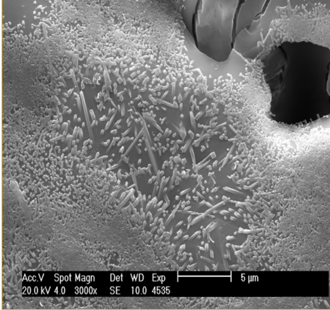
Şekil 3.14. Camsı Yapı İçinde Dağılmış İğnesel-Fibril Mullit Mikroyapısı. 43
