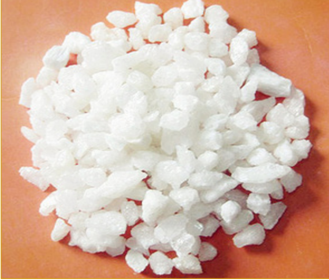
Şekil 4.2a-b. a. Beyaz ergimiş (white fused) alümina. b.Kahverengi Ergimiş (brown fused) Alümina 58
