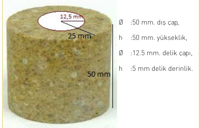
Şekil 5.4 Yük Altında Refrakterlik Testi için Standart Numune ve Boyutları
