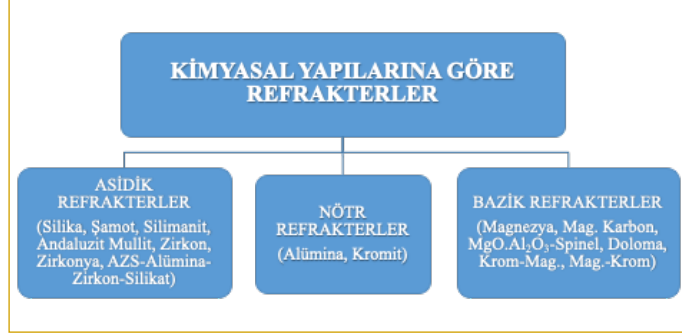
Şekil 1.1. Kimyasal Yapılarına Göre Refrakter Malzemelerin Sınıflandırılması 2
