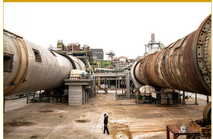
Şekil 2.11. Kalsine ve Sinter MgO Üretimi için Yatay Döner Fırını (rotary kiln) 14
