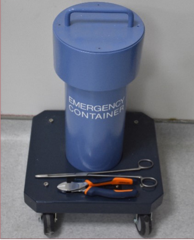
Şekil 6. Mobil acil durum konteynırı ve içinde yer alan aletler
