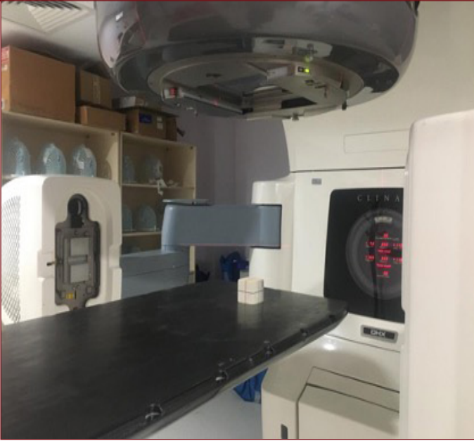
Şekil 7. Görüntüleme ekipmanlarının kontrolünde kullanılan küp
