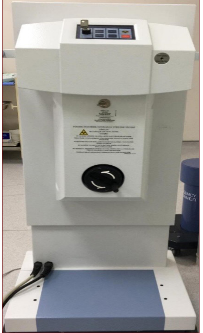
Şekil 7. Cihaz ait manuel kaynak geri çekme mekanizması
