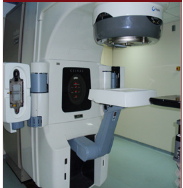
Şekil 13. Lineer hızlandırıcı cihazına entegre EPID
