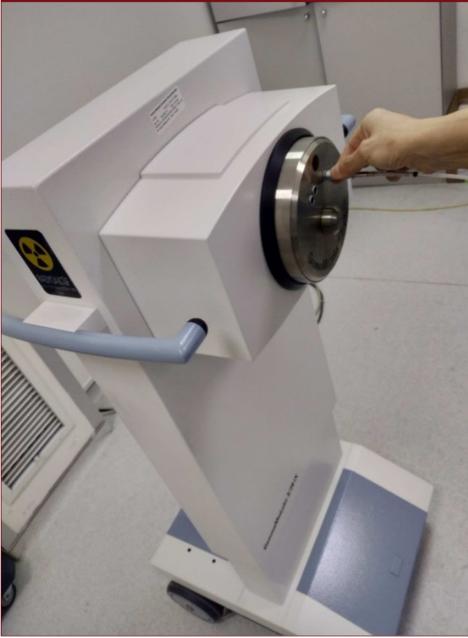
Şekil 13. Transfer kablosu kontrolü
