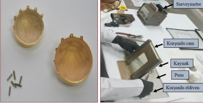
Şekil 14. I-125 sidleri, hazırlanışı ve çalışma ortamı
