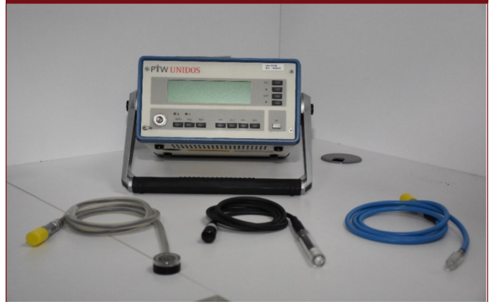
Şekil 5. Farklı tipte iyon odaları ve elektrometre
