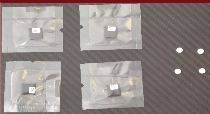
Şekil 9. Optik olarak uyarılmış/optik uyarmalı lüminesans dozimetre (sol yan) örneği ve termolüminesans dozimetre (sağ yan)
