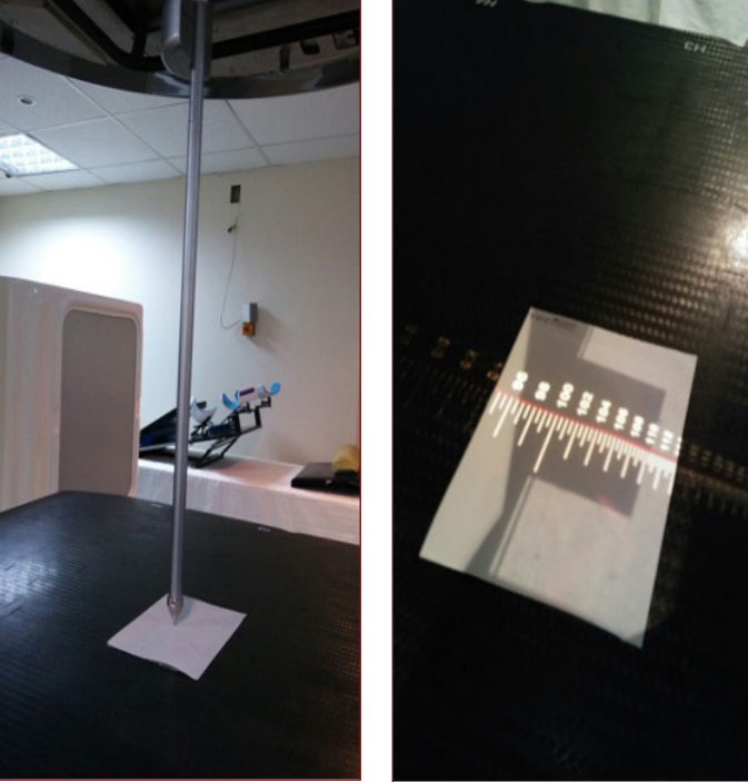
Şekil 4. SSD çubuğu ve kontrol düzeneği
