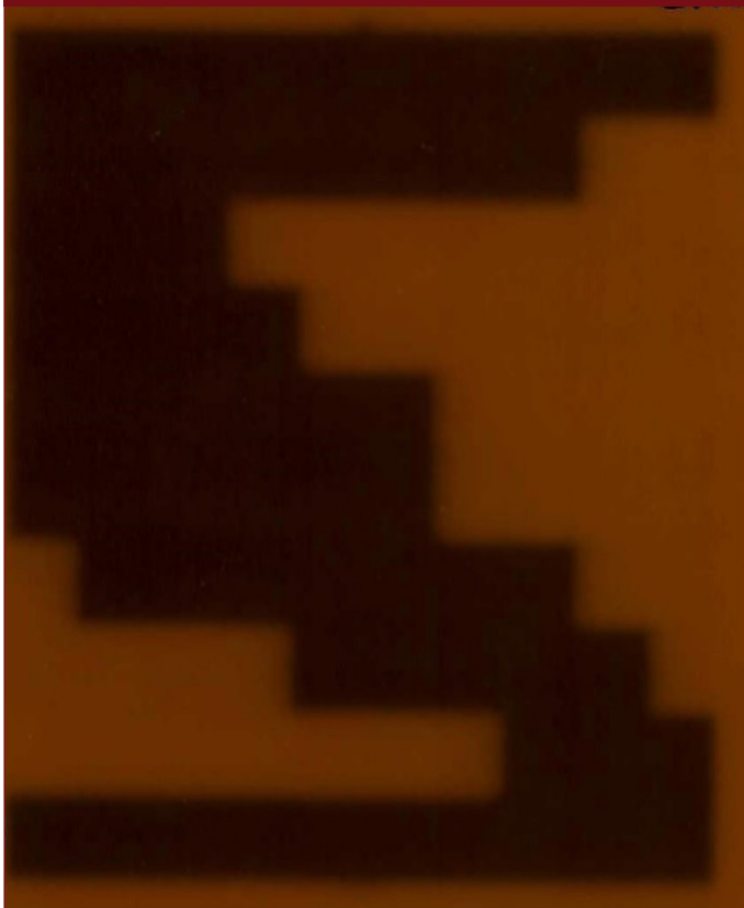
Şekil 15. Gafkromik QA filmi ile elde edilmiş lif pozisyon doęru luęu testi
